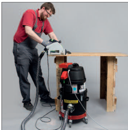
WS 200 Zone 22 met houder van antistatisch kunststof en contactdoosautomatisme voor aangesloten bewerkingsmachine
